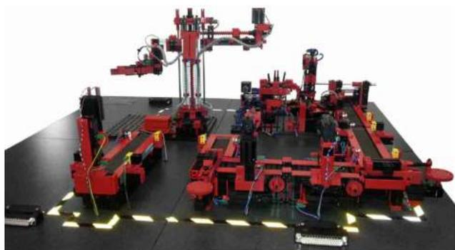
Fig. 3. Celda de Manufactura Fischertechnik
