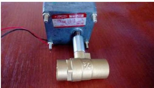
Fig. 7. Actuador de bajo costo utilizado para el control de flujo.
