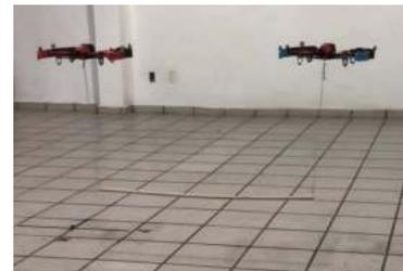
Fig. 4. Sistema compuesto por dos cuadrirrotores transportando una carga tipo barra.
