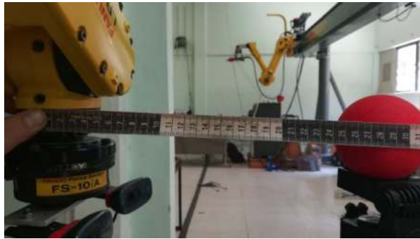
Figura 12. Medición de la separación entre el efector final del robot y la esfera 1.
