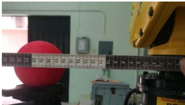
Figura 13. Medición de la separación entre el efector final del robot y la esfera 2.
