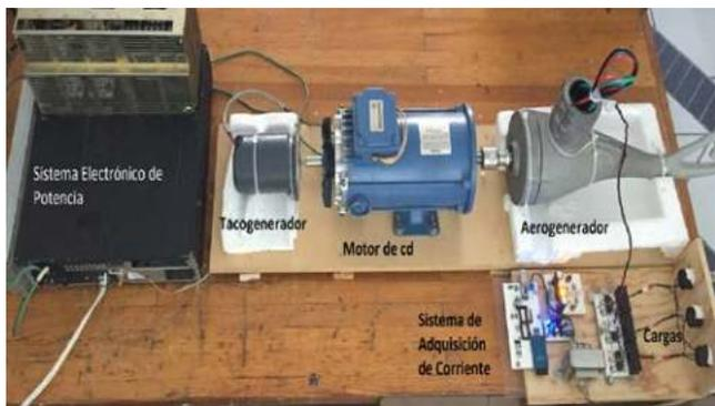
Fig. 2. Banco de pruebas para la detección de fallas de estator del PMSG de un aerogenerador.
