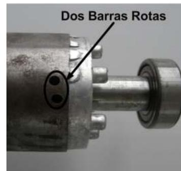
Figura 2. Dos barras rotas del rotor de un motor de inducción.
