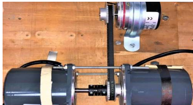
Fig. 14. Acoplamiento de los motores de inducción y el encoder.
