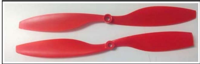
Figura 2. Hélice sin fractura y hélice con dos centímetros de desprendimiento.
