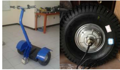
Fig. 1. Vehículo Eléctrico de dos Motores en Rueda y Motor BLDC en Rueda (SG/F15).
