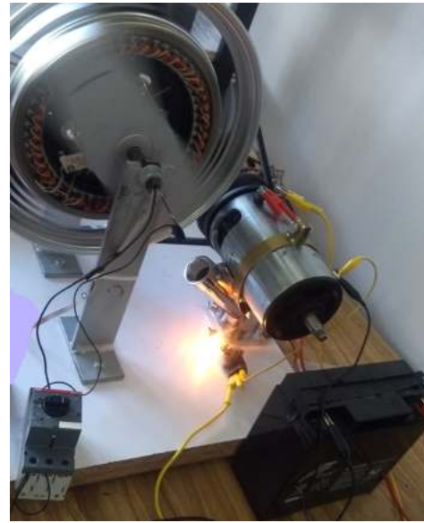
Figura 3. Acoplamiento mecánico del motor BLDC y del dínamo.
