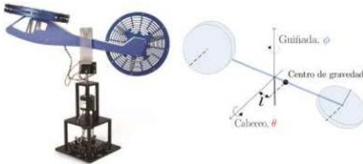
Figura 2. Modelo experimental del helicóptero *Quanser* de 2 GDL y su diagrama de cuerpo libre.
