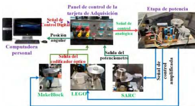
Fig. 4. Plataforma experimental utilizada para el control de los servomotores de CD.
