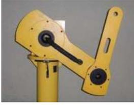
Fig. 1. Robot manipulador CICESE de dos grados de libertad
