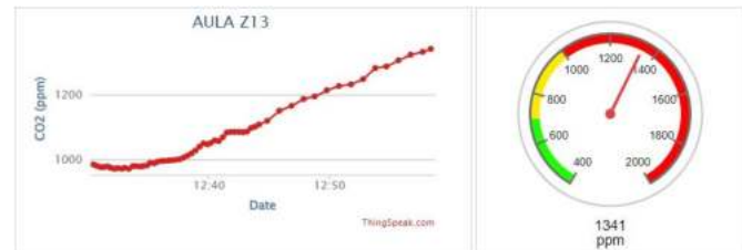
Figura 4. Interfaz de monitoreo en ThingSpeak.
