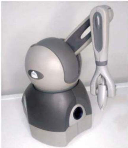
Fig. 1. Dispositivo háptico *Geomagic Touch* de 3D SYSTEMS.
