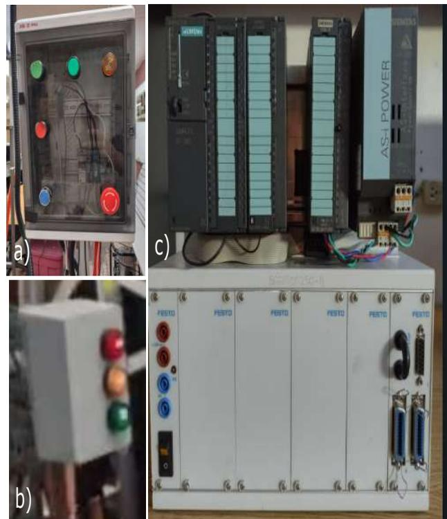
Fig. 5. Tablero de control, indicadores del proceso y PLC S7-300
