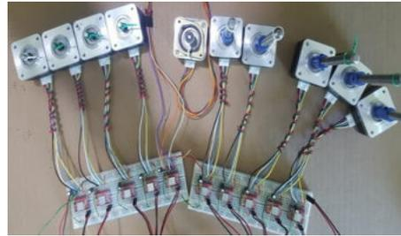
Fig. 7. Conexiones físicas de los motores con los módulos DRIVER A 4988.
