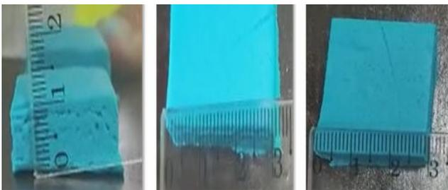
Fig. 12. Dimensión del alto de la barra (1cm), ancho de la barra (3cm) y largo de la barra (3cm).
