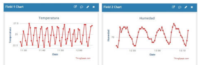
Figura 8. Gráficas de temperatura y humedad con oscilaciones sostenidas
