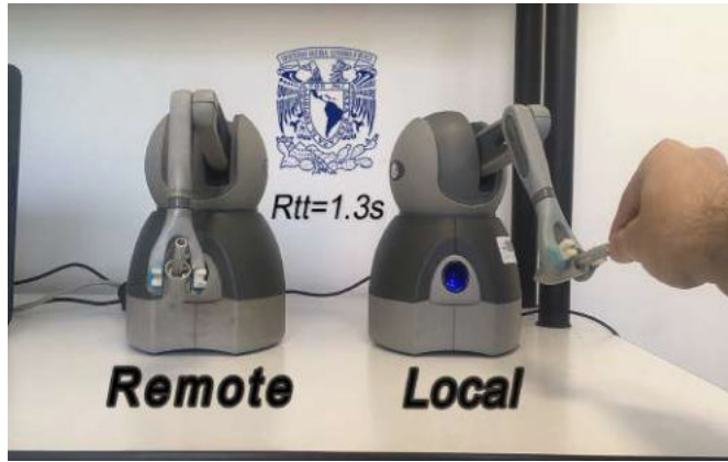
Fig. 1. Sistema de teleoperación bilateral compuesto por dos dispositivos hápticos Geomagic Touch .
