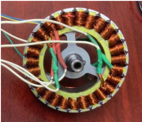
Fig. 1. Devanados del PMSM de scooter eléctrico
