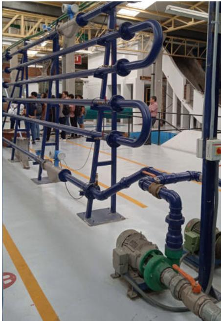
Fig. 1. Instalación hidráulica, vista parcial con la bomba hidráulica en primer plano
