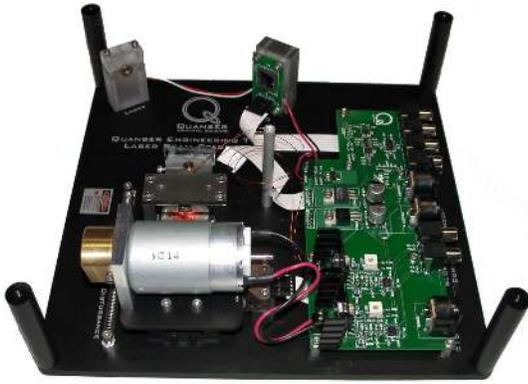
Fig. 3. Sistema LBS: Fotografía de vista superior del sistema estabilizador de haz láser (LBS) de Quanser
