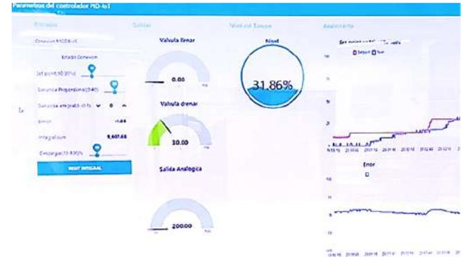
Fig. 6. Respuesta del nivel  $h_c$  en el prototipo del sistema hidráulico usando el control PI-IoT en Broker Node-RED. Imagen tomada del monitor del sistema que está operando en tiempo real.
