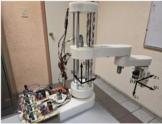
Figura 3. Robot manipulador SCARA de cuatro grados de libertad.
