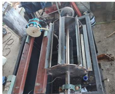
Fig. 7. Tambor giratorio para el desgaste de fibra. Fuente: elaboración propia.
