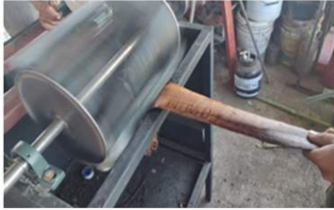
Fig. 14. Pruebas de funcionamiento de extracción de fibra. Fuente: elaboración propia.
