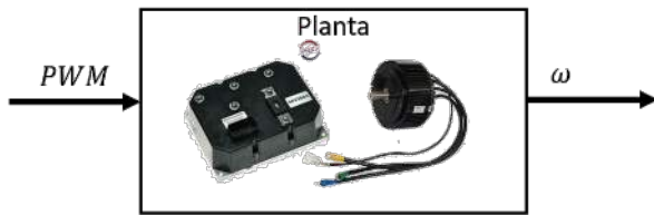
Fig. 1. Sistema entrada salida conformado por el driver HPC300 y el motor BLDC HPM5000.
