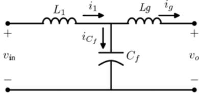
Fig. 1. Lossless LCL Filter
