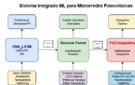
Figura 1. Arquitectura del sistema integrado mostrando flujo secuencial de datos y configuración automática entre módulos
