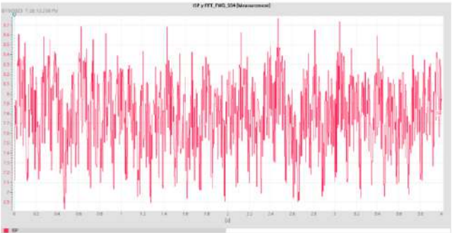
Fig. 3. ISP de las corrientes de fase del motor.
