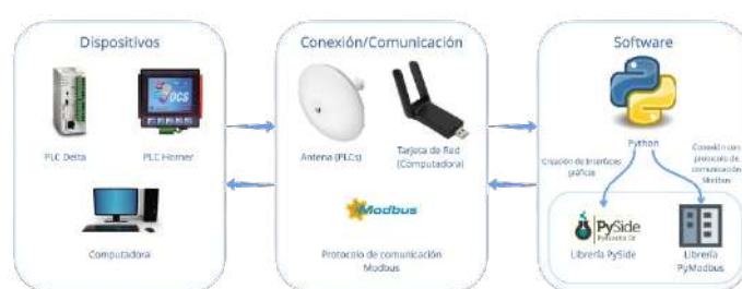
Fig. 6. Elementos que conforman el flujo. Comunicación PLC-PC vía Modbus TCP con interfaz en Python.
