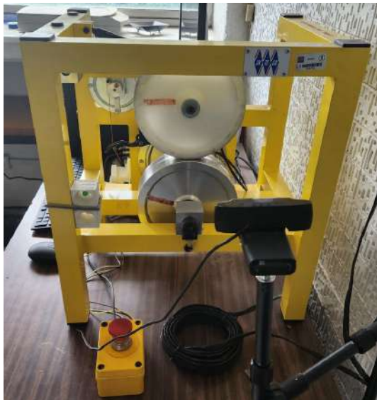
Fig. 5. Imagen del equipo experimental instalado en el laboratorio: freno ABS de la marca Inteco.
