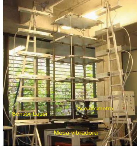
Figura 3. Edificio de cinco pisos escala reducida
