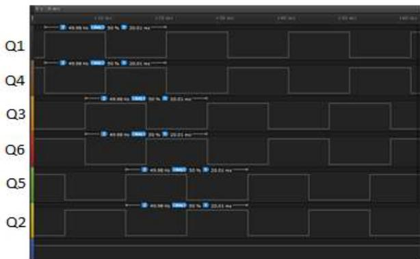
Figura 8. Señales de control PWM para los interruptores a 50Hz.
