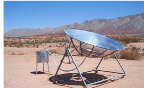
Fig. 2. Concentrador de tipo Fresnel de bajo costo para el proceso de pasteurización solar (Panchal, Patel, and Chaudhary 2018)
